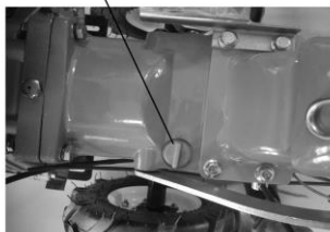
Fig. 5 – Verificarea nivelului de ulei transmisie
